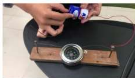
Gambar 1. Percobaan medan magnet disekitar kawat berarus menggunakan kompas.
